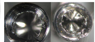
Fig.6 Tornillo Allen original (izq.) y ensayados (der.)
