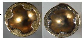
Fig.5 Vista interior llave BHS recubierta con TiN antes del ensayo (izq.) y después (der.).
