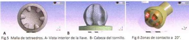
Fig.5 Malla de tetraedros. A- Vista interior de la llave. B- Cabeza del tornillo.
